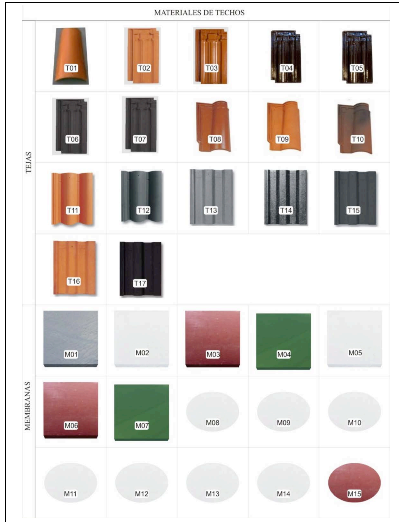
Figura 2. Imágenes de los materiales de techos evaluados. Tejas tradicionales -cerámicas y cementicias- (T01 a T16) y con compuesto reciclado (T17); membranas asfálticas –aluminio y geotextil- (M01 a M07) y líquidas (M08 a M15)
