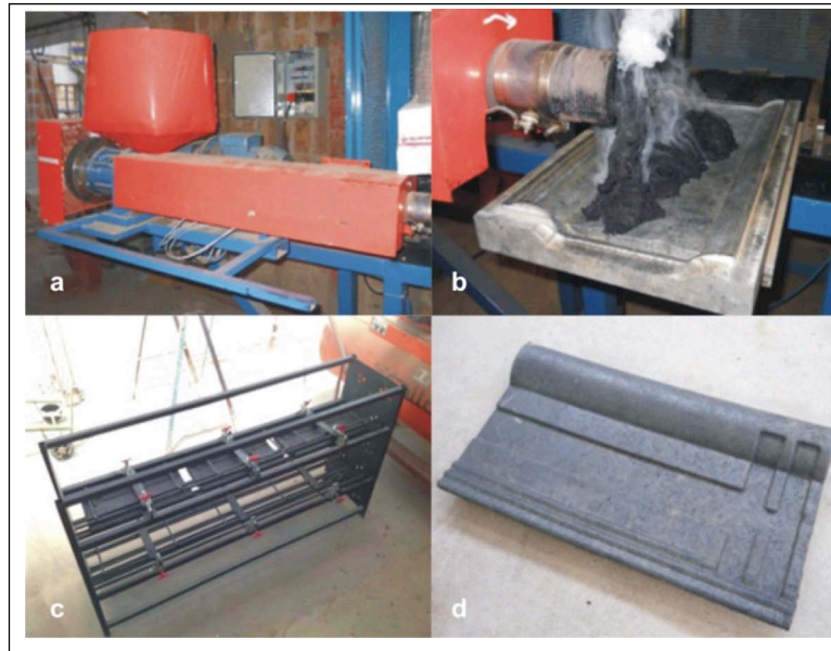
Figura 1. Proceso de fabricación de teja reciclada. (a) Vista general de la maquina extrusora, (b) mezcla caliente dispuesta sobre matriz; (c) bastidor de secado; (d) muestra terminada
