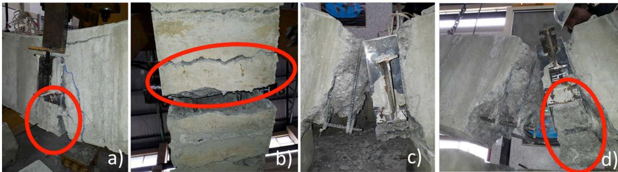
Figura 13. Forma del daño en la viga ensayada
