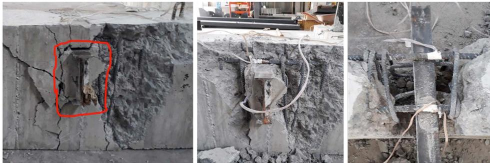
Figura 10. Modelos MA ensayados en sentido longitudinal del nudo
