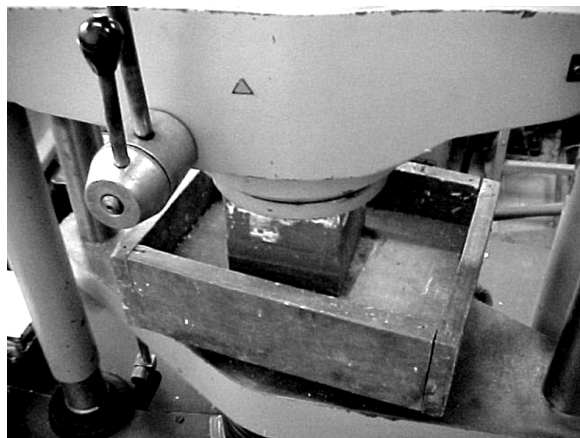
Figura 2. Ladrillos sobre compresión simple
