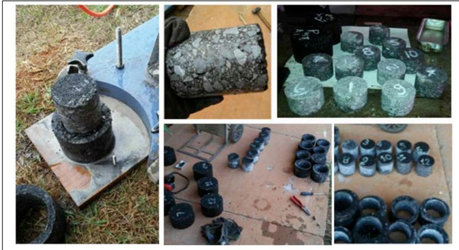
**Figura 1.** Proceso de preparación de los cuerpos de pruebas.
