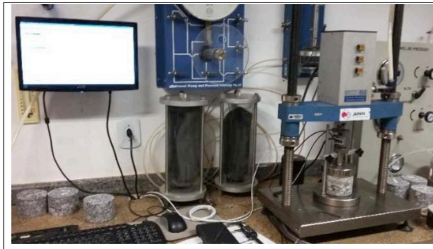
**Figura 3.** Ensayo de fluencia estática.
