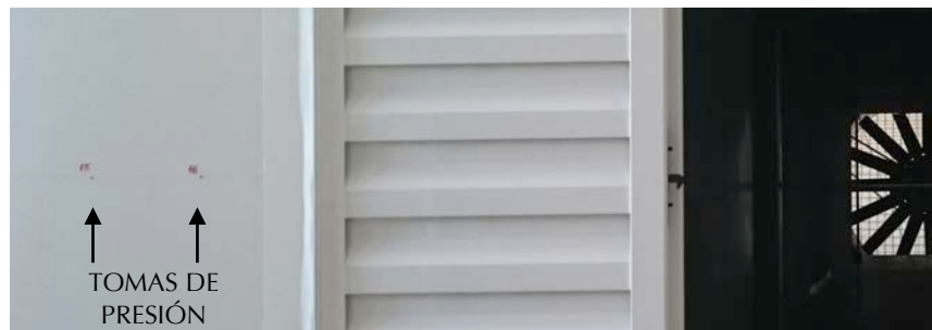
Figura 5. Tablero con una muestra de ventana y las tomas de presión a la izquierda.
